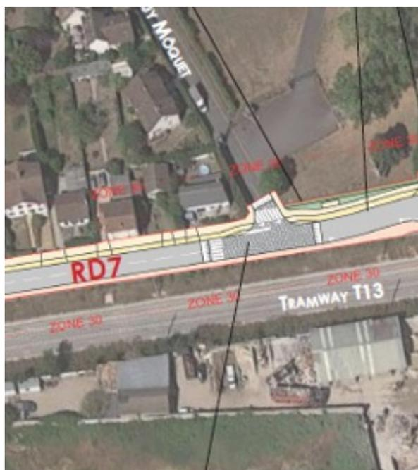
Plateau en enrobé hydrodécapé afin de marquer l'intersection et de la sécuriser
