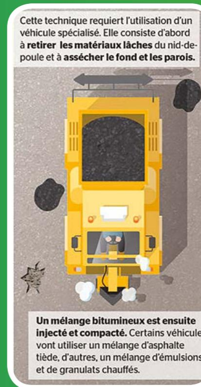
Cette technique requiert l'utilisation d'un véhicule spécialisé. Elle consiste d'abord à retirer les matériaux lâches du nid-de-poule et à assécher le fond et les parois.
