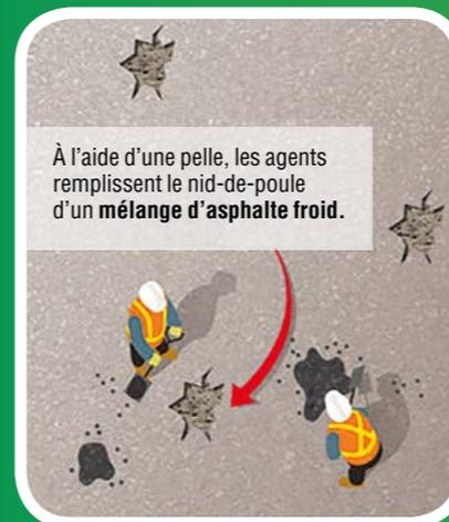
À l'aide d'une pelle, les agents remplissent le nid-de-poule d'un mélange d'asphalte froid.
