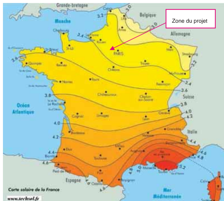
Figure 21: Ensoleillement en kWh par m 2 par jour (Source : Techsol)
